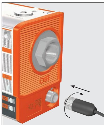
Un unique connecteur M12x1 à 5 broches, avec un degré de protection IP67, permet de connecter à la fois le pressostat et le démarreur progressif ou la vanne de sectionnement. Ce système réduit le temps de câblage et améliore la fiabilité des raccordements. Une fois raccordé sur ONE le degré de protection de l'ensemble devient IP65.
